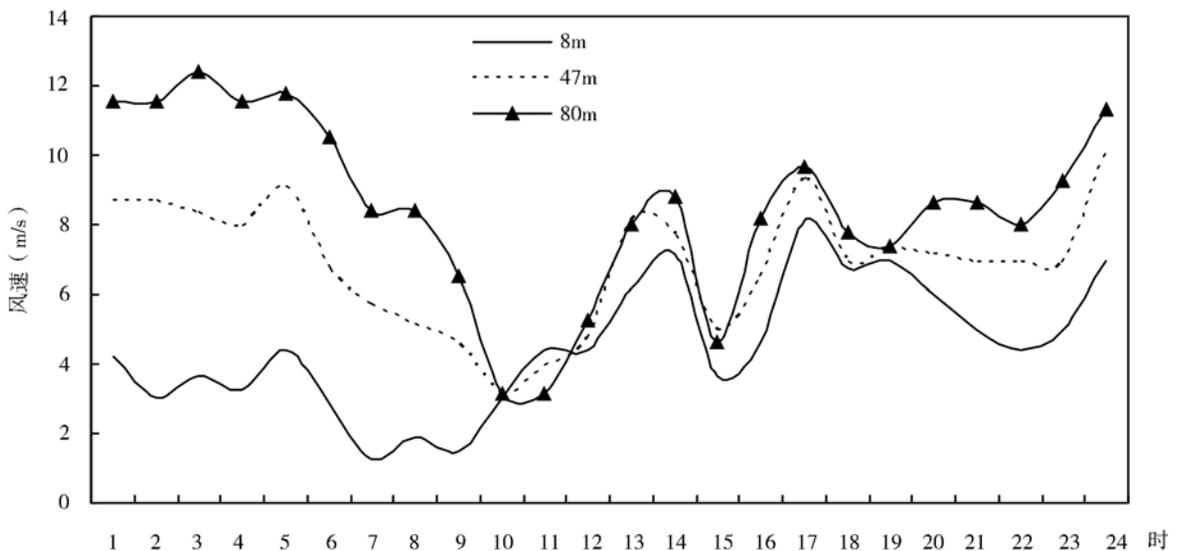
图 2 2008 年 9 月 20 日各高度浅层风日变化
