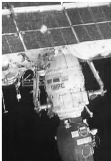
图 37 安装在纵码头号对接间(未来最终构型见图 1)侧面上的一对“天箭”号吊机 [33]
