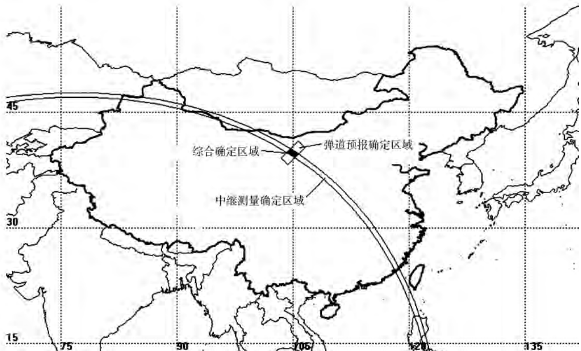
图 2 单颗中继卫星对载人飞船返回舱的定位原理示意图
